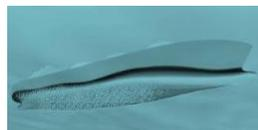
Sperimentazione di air lubrication e air bubbling su modelli di scafo
