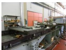
Azionamento di banchi per prove di fatica con unità oleoidrauliche servo-controllate (in collaborazione con MASTEL)
