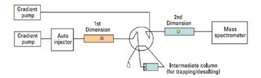
tipo 2: il campione viene separato attraverso una prima dimensione cromatografica utilizzando un sistema di pompaggio a gradiente. Le frazioni ottenute e raccolte mediante un raccoglitore di frazioni integrato nello strumento, vengono injettate mediante auto campionatore per essere sottoposte ad una seconda dimensione separativa in gradiente. In tal modo l'operatore non è coinvolto in alcun modo nella manipolazione del campione.
