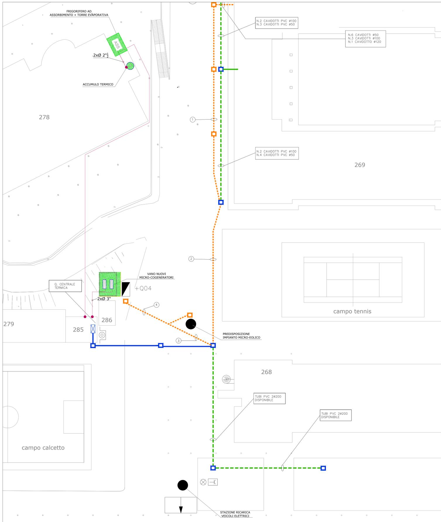
(1) n. 2 cavidotti interrati in PVC serie pesante ø200
