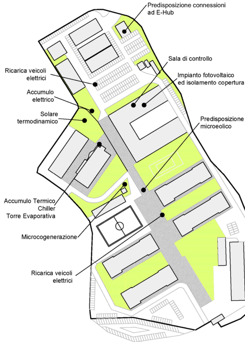
Figura 3.1: Layout di Posizionamento degli Impianti
