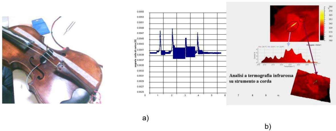
Analisi vibratoria di singole parti di strumento: esempio di indagine su cordiera.
