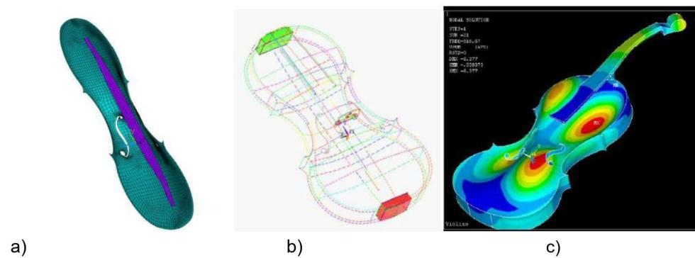
*Analisi speciali:* determinazione delle forze statiche e dinamiche all'interno dello strumento (a); analisi termografiche (b).
