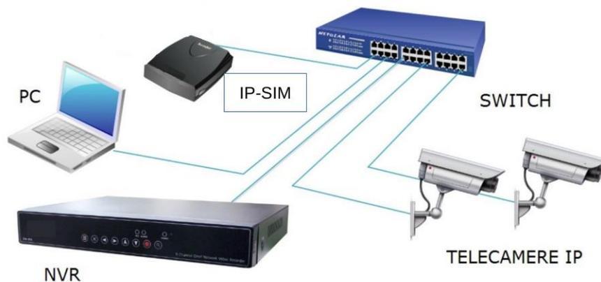
Funzione del nodo IP-SIM è l'analisi in tempo reale di più flussi video, fornendo alla piattaforma di gestione innovative capacità di interpretazione delle immagini basate su reti neurali convoluzionali profonde (DCNN) e/o vision transformers (VT).
